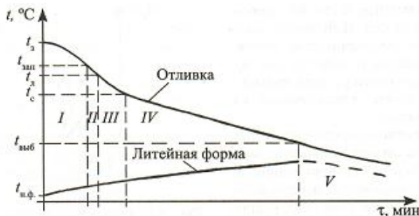
Рисунок 4. Изменение температуры отливки и формы в процессе изготовления отливки
